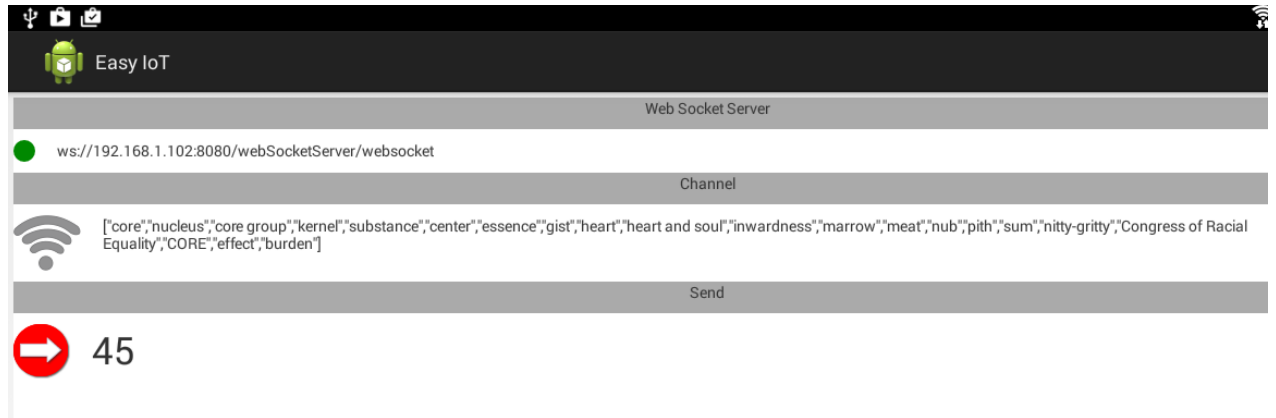
Figura 5.17: Aplicación cliente conectada con el tag “heart”. Captura de pantalla de la aplicación cliente utilizando el mismo canal creado bajo el tag “heart”.
