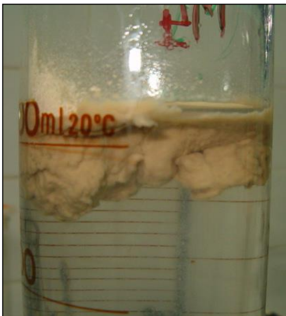
Figura 5.10. Aglomeración de las partículas de material arcilloso.
