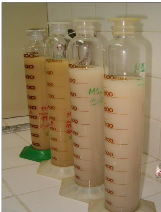
Figura 5.12. Inicio de corte granulométrico por sedimentación.
