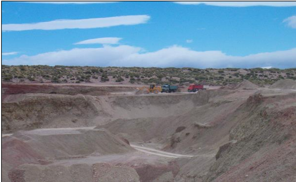
Figura 4.5. Explotación a cielo abierto del banco de bentonita en el yacimiento 7 de Mayo.
