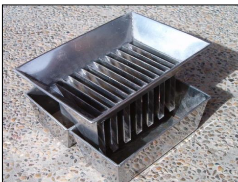
Imagen 5.3. Cuarteador de rifles tipo John usado para disminuir el volumen del material previamente triturado.
