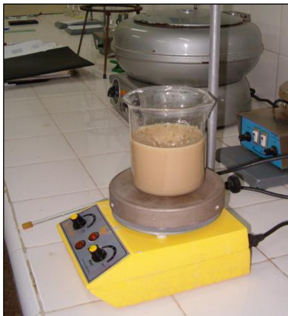
Figura 5.11. Preparación de una suspensión para su posterior separación por decantación.
