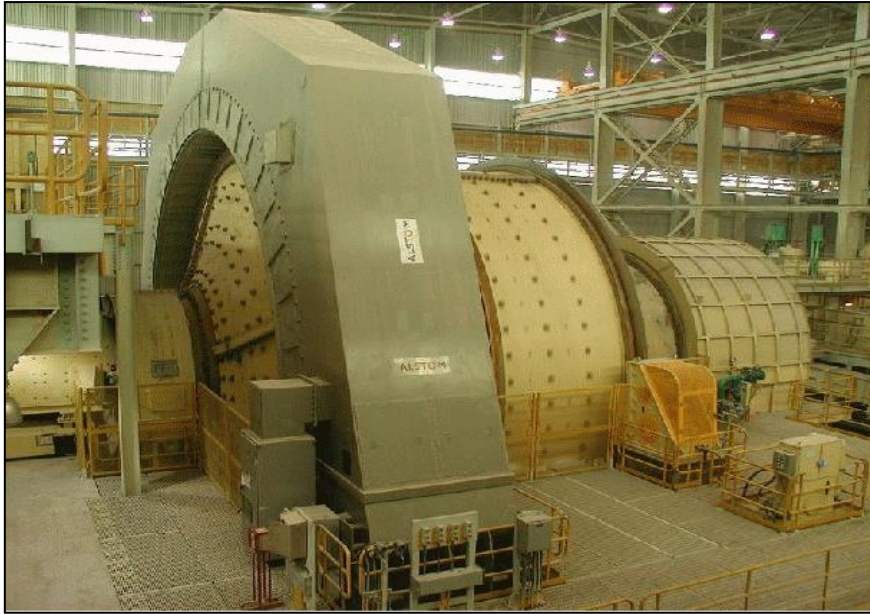
Figura 2.5. Molino en operación, equipo utilizado en la segunda etapa de reducción granulométrica.
