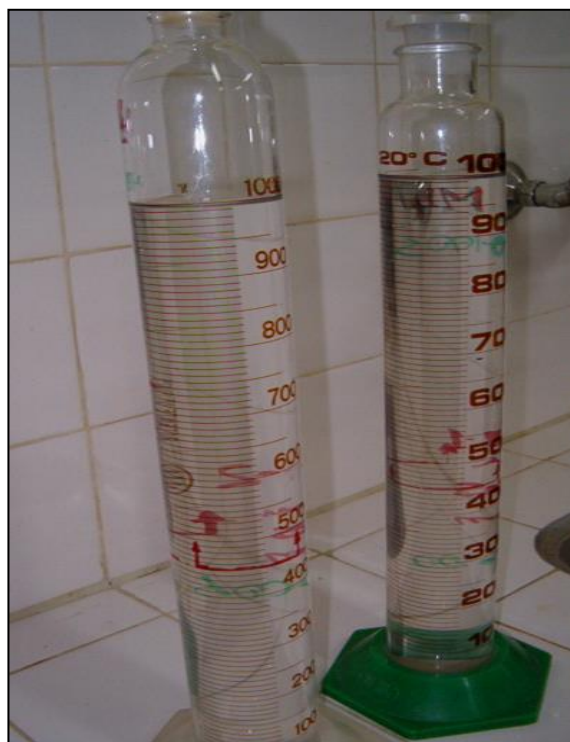
Figura 5.13. Finalización de la clasificación, puede observarse el material decantado.
