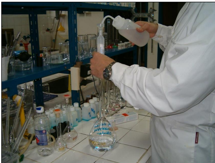
Figura 5.18. Preparación de la solución madre de Pb empleando el reactivo Standard Titrisol Merck®, mostrado en la imagen anterior.
