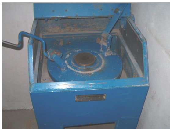
Figura 5.6. Pulverizador de anillos, puede apreciarse el plato vibratorio.
