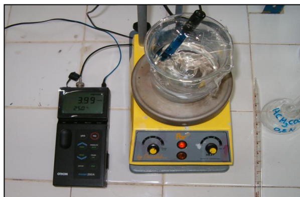
Figura 5.20. Preparación de la solución amortiguadora para el ajustar a 4 el pH del sistema de adsorción.
