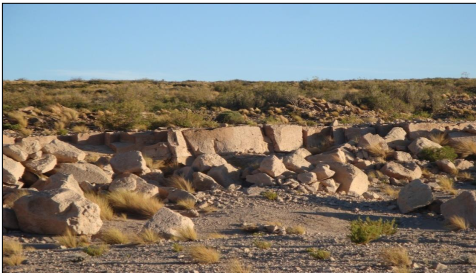
Figura 4.9. Cantera abierta en el yacimiento Los Pozones, puede observarse la escasa capa de estériles suprayacente.
