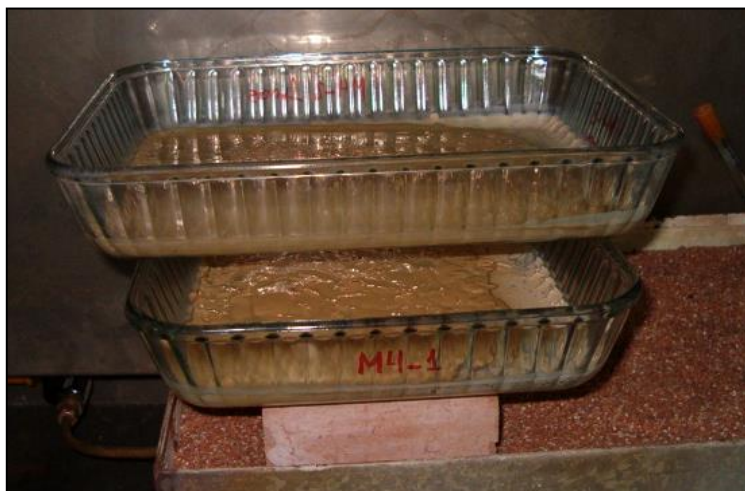
Figura 5.14. Secado de las partículas extraídas, en baño de arena.
