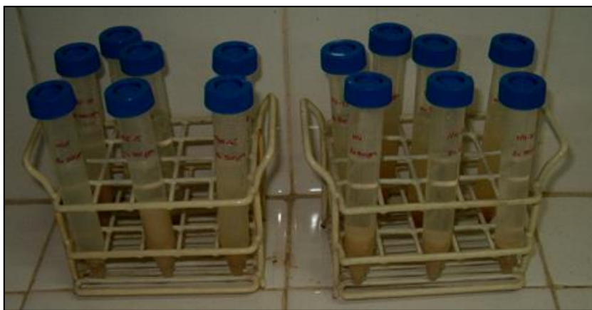
Figura 5.23. Experiencias de adsorción en sistema batch con soluciones polisoluta, usando como adsorbente la fracción M4 en forma de polvo, M4CdPbZn.
