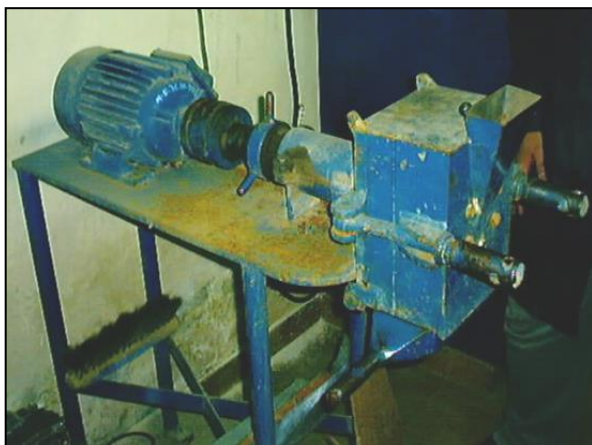
Figura 5.4. Molino a discos en operación, equipo usado para la molienda primaria.
