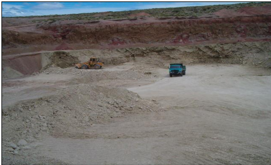
Figura 4.4. Pala cargadora efectuando tareas de destape en el yacimiento 7 de Mayo.
