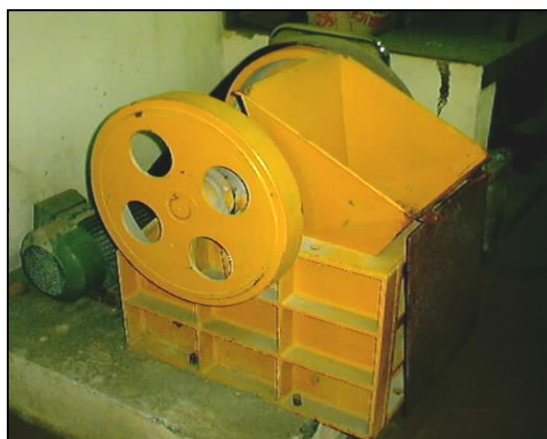
Figura 5.2. Trituradora de mandíbula usada para la reducción granulométrica de los materiales adsorbentes.
