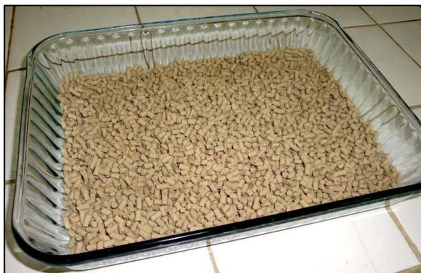
Figura 5.15. Extrudados secos y clasificados por tamización.
