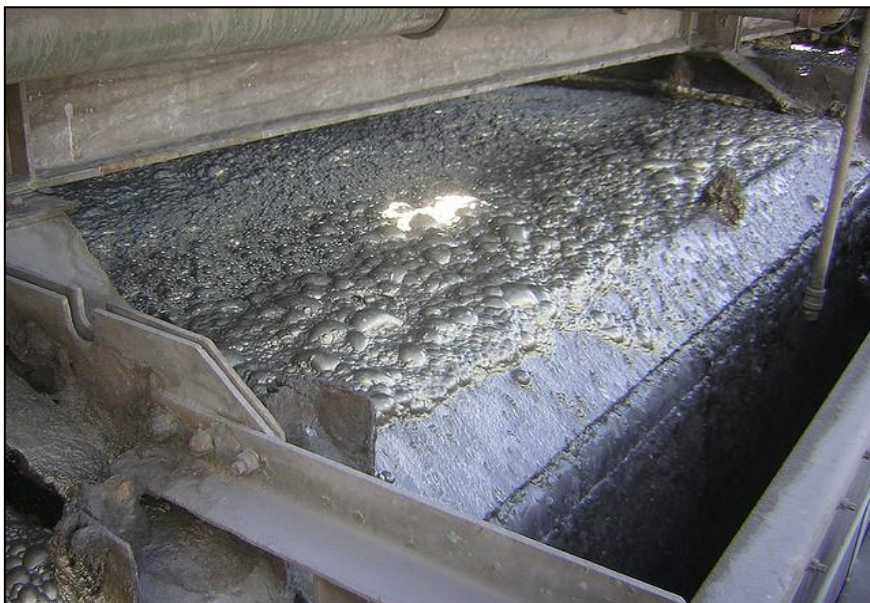
Figura 2.6. Etapa de concentración, puede apreciarse la espuma que transporta el material valioso hacia la parte superior de la celda.
