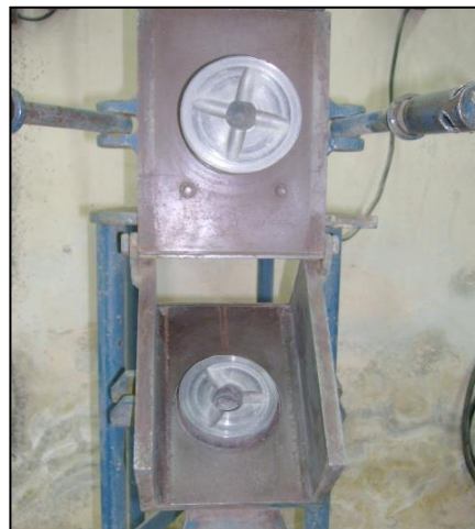
Figura 5.5. Interior del molino, donde puede observarse la conformación de los discos.
