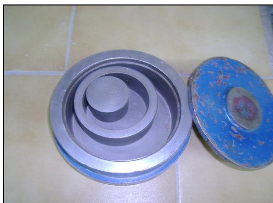
Figura 5.8. Juego de molienda conformado por el recipiente porta anillos y dos anillos concéntricos.
