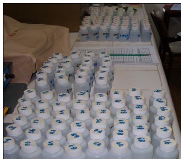
Figura 5.22. Soluciones envasadas para cuantificar el ión remanente en solución por EAA.
