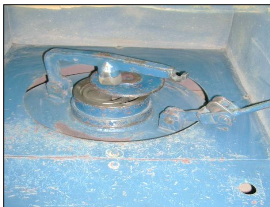
Figura 5.7. Recipiente de molienda sobre el plato vibratorio, también se observan los ganchos de sujeción.
