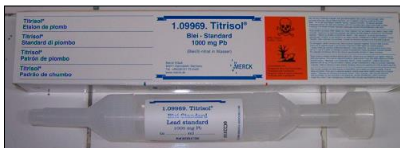
Figura 5.17. Solución de Pb Standard Titrisol Merck®, reactivo utilizado para la preparación de la solución primaria o madre de este ion.
