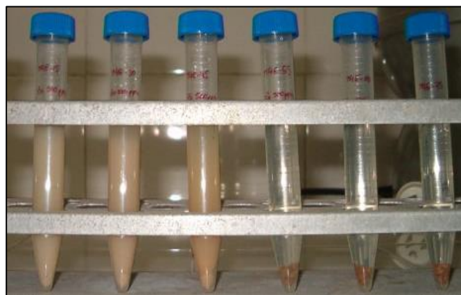
Figura 6.27. Uso como adsorbente de la muestra M4 extrudada en estado natural y térmicamente modificada a distintos rangos: 150 – 300 – 450 – 550 – 650 y 750 °C
