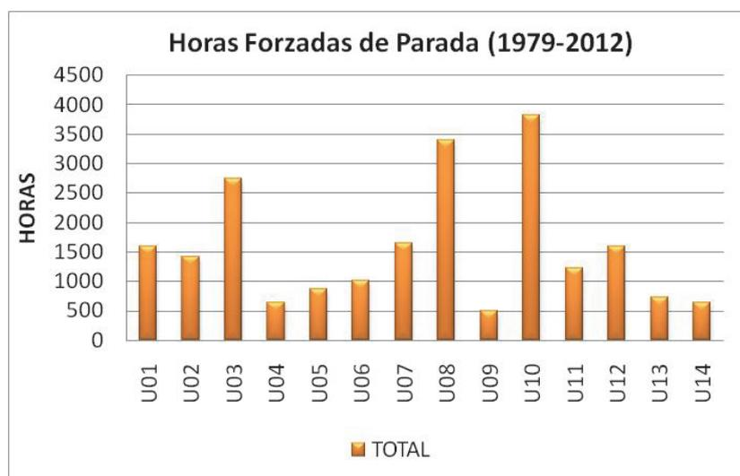
FIG. 4.12: HORAS TOTALES DE PARADA FORZADA EN LAS UNIDADES SG.
