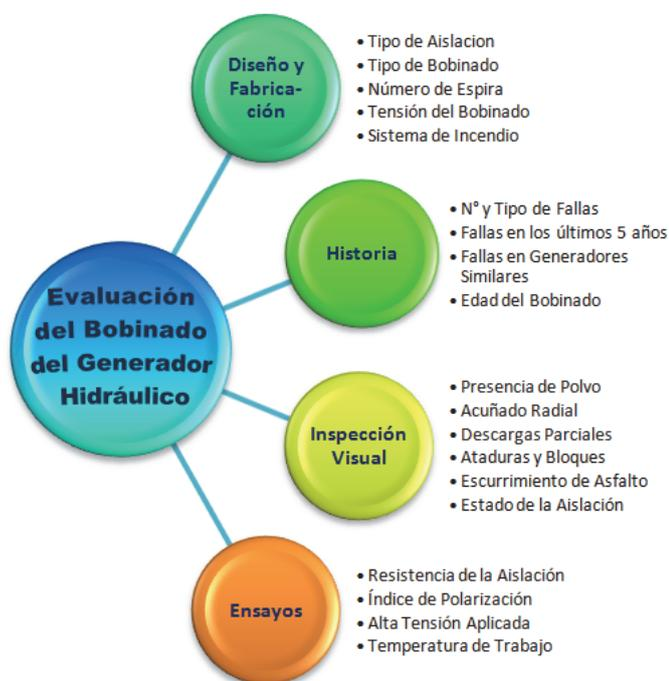
FIG. 7.1: ITEMS DE EVALUACIÓN DEL BOBINADO DEL GENERADOR HIDRÁULICO (AIE)
