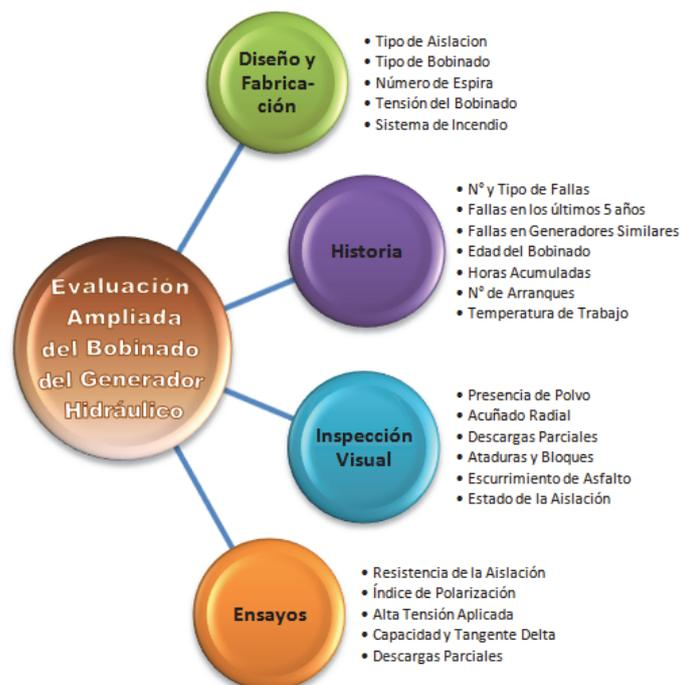
**FIG. 7.2: ÍTEMS AMPLIADOS PARA EVALUACION DEL BOBINADO DEL GENERADOR HIDRAULICO**
