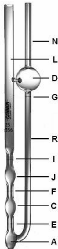
Figura 2.1: Viscosímetro Cannon-Fenske (flujo invertido) para líquidos opacos y transparentes
