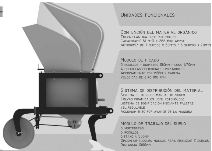
Funcionamiento y partes de la biofumigadora
