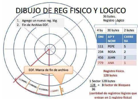
Fig.10: Esquemización de registros lógicos y físicos; concepto de factor de bloqueo.
