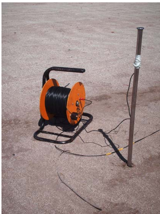
Figura 2.17. Electrodo de acero inoxidable para emisión de corriente
