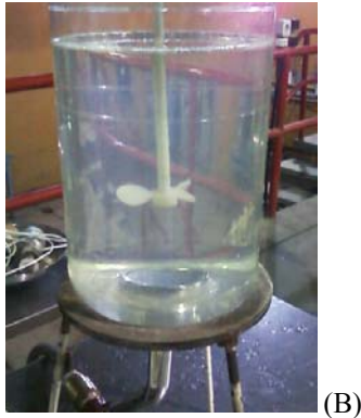
Fig. 1: Equipo diseñado para la separación de corteza y membrana. (A) instalación y (B) tanque de separación.
