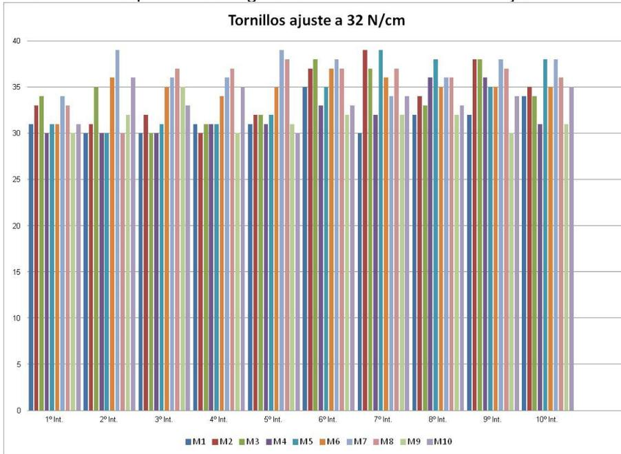
Referencia: En el eje vertical se observan los valores de desajuste expresados en N/cm en intervalo de 5, en el eje horizontal se observan los intentos de desajuste. M es igual a muestra N°.
