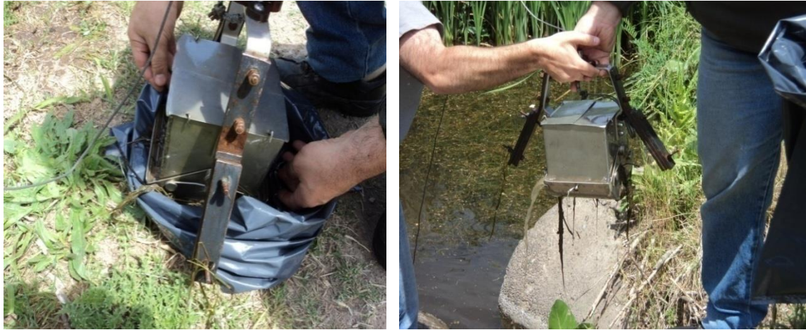
Figura 9. Proceso de extracción de sedimentos de cauce.
