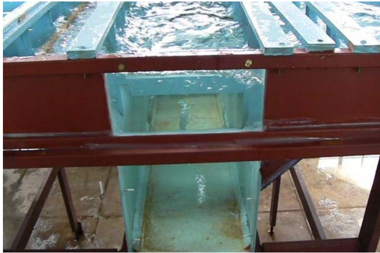
Figura 7.- Formación de vórtice longitudinal en el canal de derivación correspondiente a la derivación mediante orificios observada durante la modelación física.
