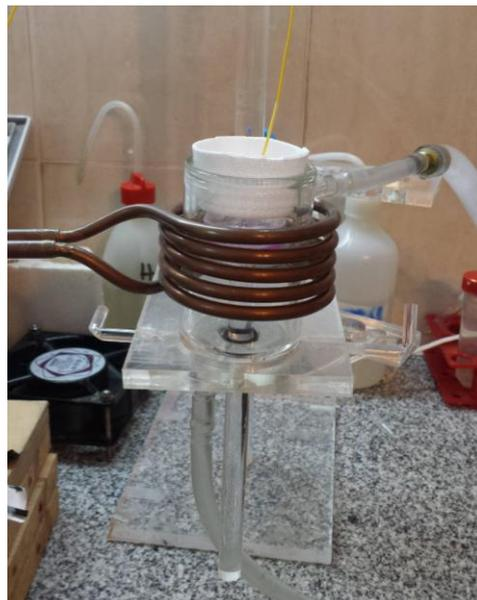
Figura 2.2: Imagen de la bobina de 7 cm conteniendo el recipiente para aplicación de RF en cultivos celulares en baño térmico a 37 °C
