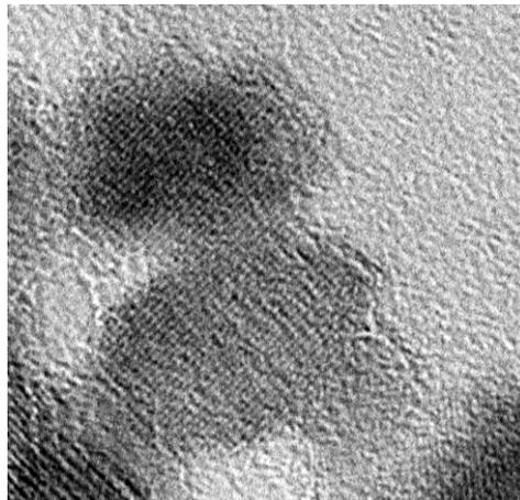
*Figura 3.7: partícula aislada del coloide  $AC-Fe_3O_4(60d)$  donde se visualizan los planos cristalinos*
