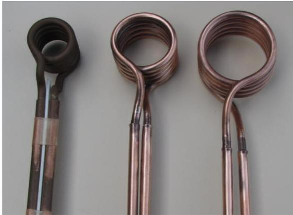
Figura 2.3: Bobinas utilizadas para aplicar campo de RF a la suspensión coloidal magnética, al cultivo celular y cultivo celular en baño térmico a 37 °C.
