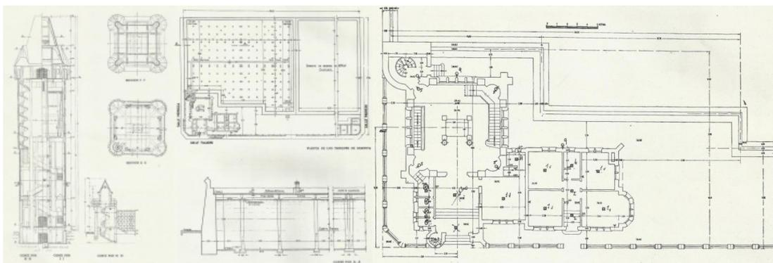
**Figuras 11, 12 y 13. Secciones y plantas de la torre y de los depósitos. Planta acceso principal. (Fuente: Lange, Revista de Arquitectura, n.274: 377-378-379)**
