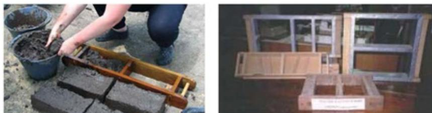
Fig. 15. Ejemplos de moldes para fabricación de adobes artesanales
