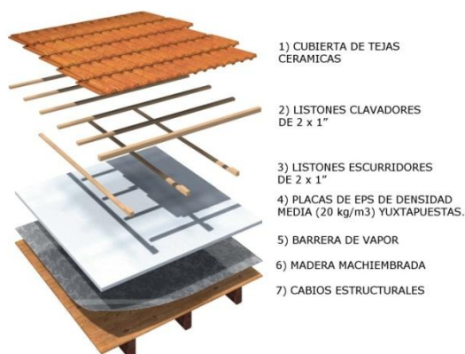
Fig.14- Despiece cubierta transventilada de tejas.
