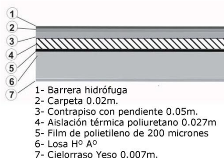
Fig. 12- Detalles cubierta hormigón armado.
