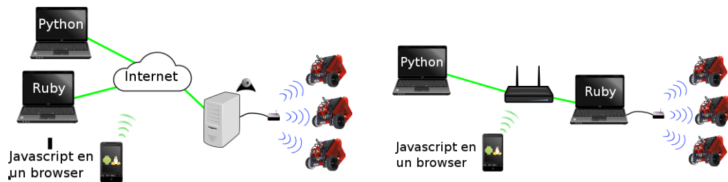
(a) Esquema de conexión de XRemoteBot en modo “servidor público” (b) Esquema de conexión de XRemoteBot en modo “LAN”
