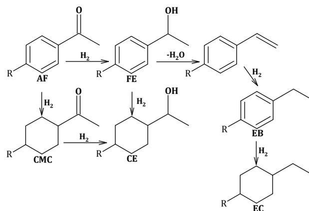
Figura 1. Posibles productos de hidrogenación de cetonas aromáticas. EB = etil benceno; EC = etil ciclohexano; ciclohexil metil cetona; ciclohexil etanol; feniletanol y sus derivados sustituidos.
