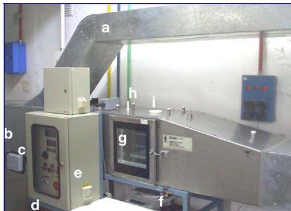
**Figura 1.1.** Túnel de secado
