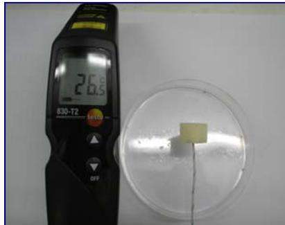
**Figura 2.4 .** Medición de la temperatura del centro de un cubo de manzana
