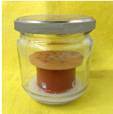
Figura 3.26. Sistema de equilibrio gravimétrico, frasco conteniendo la solución saturada de NaCl.
