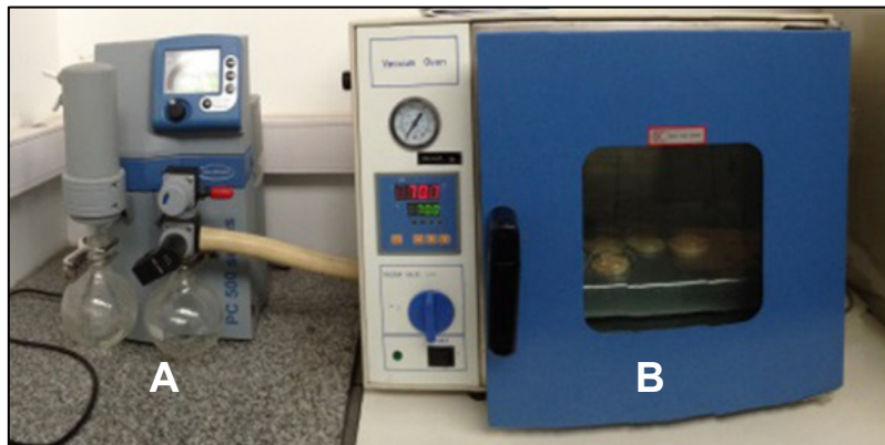
Figura 4.41. Equipo de secado a vacío, (A) bomba de diafragma, (B) cámara de secado.
