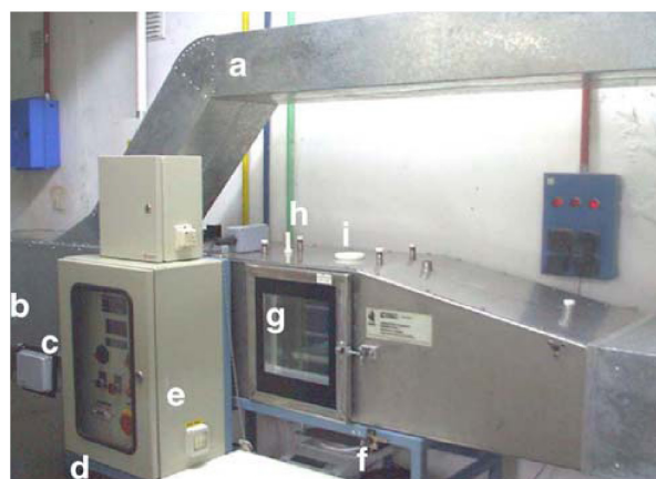
Figura 4.38. Túnel de secado con pesada in situ .
