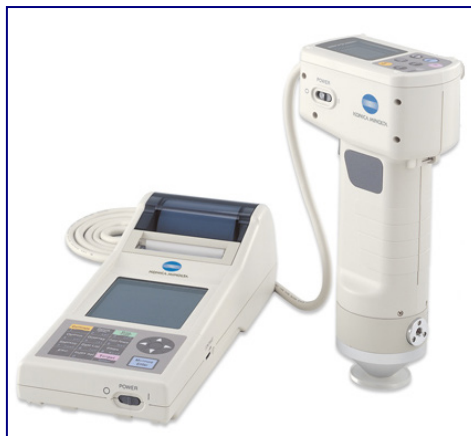
Figura 1.9. Colorímetro Konica-Minolta CR-400, Cabezal y procesador de datos
