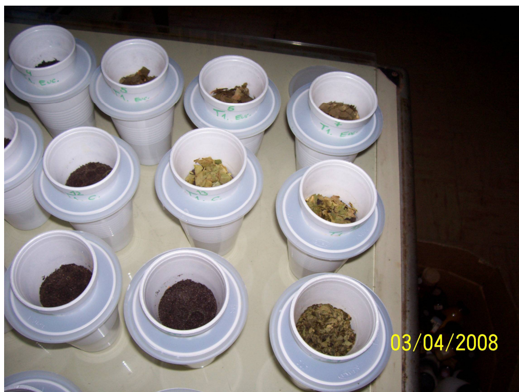
Imagen 4.1. Microlisímetros con material ES y MM, sobre el vaso colector de solución de lavado.
