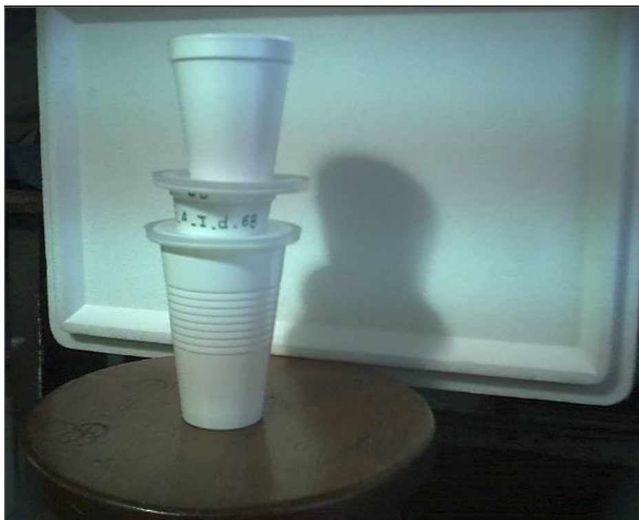
Imagen 2.1. Microlisímetro con vaso colector por debajo, y vaso para incorporación de solución de lavado por arriba.
