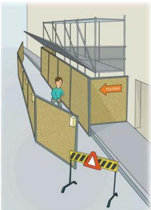
Imagen 14: Delimitación del área de trabajo. FUENTE: CÁMARA CHILENA DE LA CONSTRUCCIÓN. Manual de andamios. Comité de especialistas.
