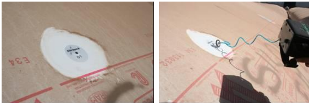
Figura 3.3. Arriba: Detalle de los puntos de medición de \text{CO}_2 a lo largo del silobolsa. Importante: la orientación correcta de la bolsa debe ser norte – sur para lograr una exposición a la radiación solar equivalente en ambos laterales de la misma. Godoy (2010). Abajo: detalle del parche destinado al punto de medición y del equipo en funcionamiento.
