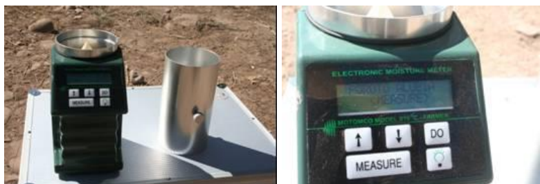
Figura 3.7. Humedímetro portátil Motomco, el cual cuenta con las curvas de poroto blanco alubia INTA Cerrillos.
