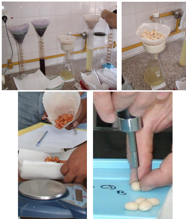
Figura 3.9. Procesamiento de muestras de poroto en el Laboratorio de Calidad Culinaria del INTA EEA Salta. Arriba: colado de los granos cocidos y detalle del caldo obtenido. Abajo: (Izq.) Pesado de la muestra remojada. Der.) Empleo del penetrómetro. De Simone et al. (2009).
