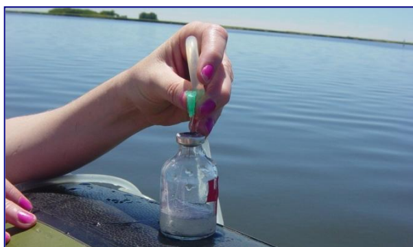
Figura 2.9. Recolección de muestras de agua para la determinación de CH_4 disuelto
