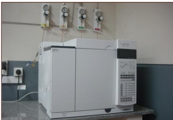
Figura 2.13. Cromatógrafo gaseoso GC Agilent 7890 A en el IFAS, UNCPBA
