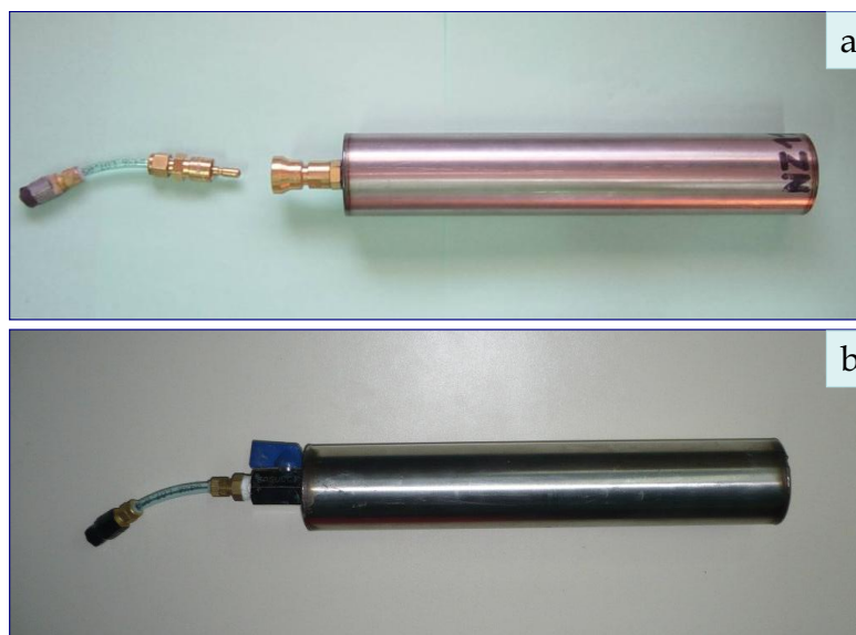
Figura 2.5. Tubo de acero inoxidable y restrictor de ingreso de aire. Tubos de acero inoxidable con válvulas a) Quick Conector Swagelok y b) esférica - Casucci
