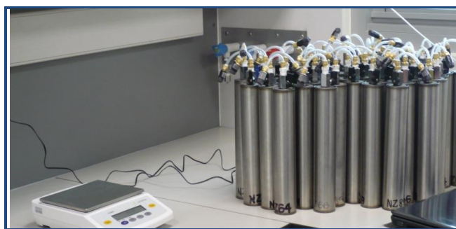
Figura 1.3. Prueba de restrictores de ingreso en recipientes de acero inoxidable con válvula esférica - CASUCCI
