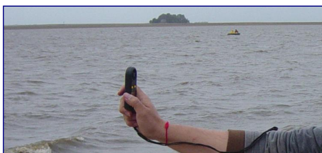
Figura 2.10. Anemómetro portátil para la determinación in situ de la velocidad del viento y la temperatura del aire
