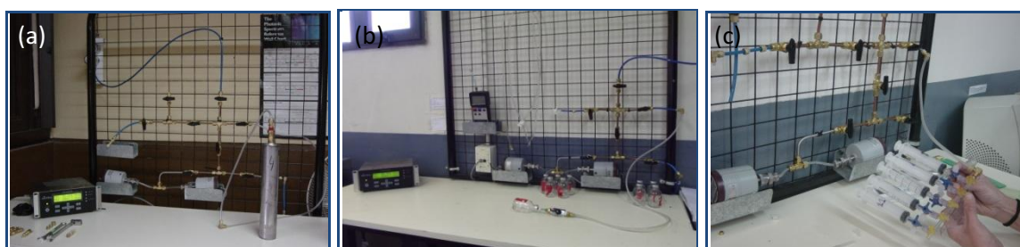
Figura 1.4 Limpieza del material de muestreo adosado al retículo de vacío: a) limpieza de recipientes de acero inoxidable; b) limpieza de frascos de vidrio; c) manual y limpieza de jeringas.
