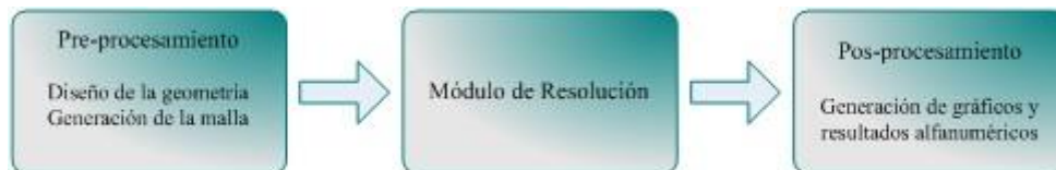
Figura 3.3. Estructura del paquete de CFD comercial
