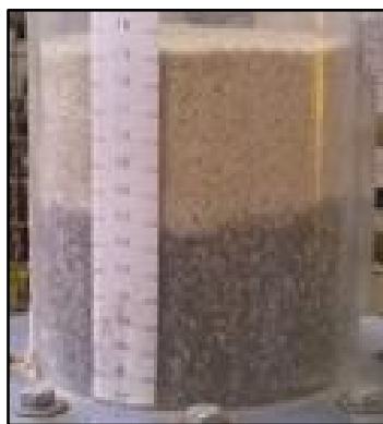
Figura 5.3. Disposición inicial de arena y biomasa en ensayos con mezclas. La imagen corresponde al ensayo con 58,4% del volumen total del sistema ocupado por biomasa.
