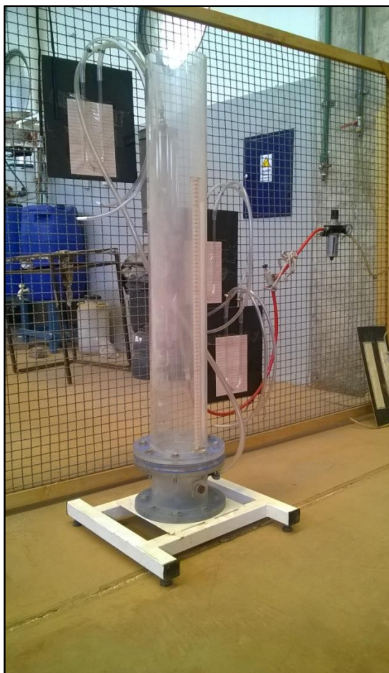
Figura 5.1. Lecho fluidizado de acrílico a escala de laboratorio (Instituto de Ingeniería Química, Universidad Nacional de San Juan)
