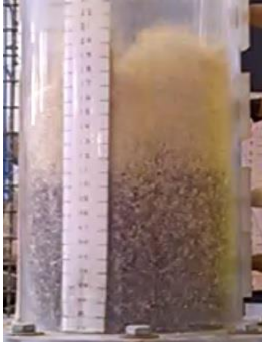
Figura 5.10. Segregación observada experimentalmente para el sistema aire-arena-biomasa (58,4%)
