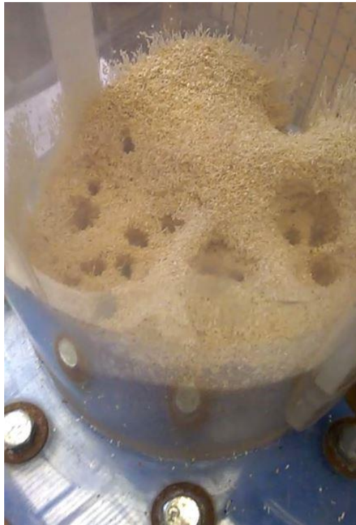
Figura 5.9. Canalizaciones observadas en las experiencias realizadas con biomasa (sin arena)
