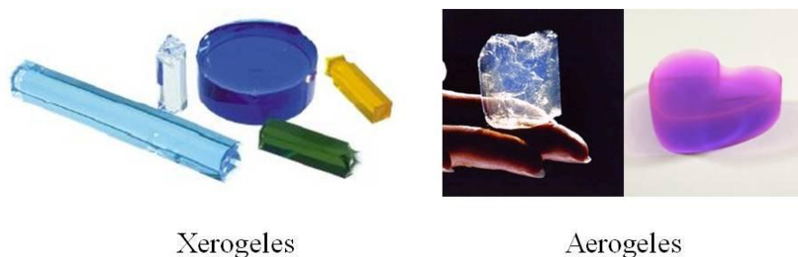
Figura 1.2.2. Ejemplos de xerogeles 162 y aerogeles 163 .
