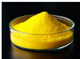
Figura 2.1. Heteropoliácido utilizado en las síntesis, H_3[PMo_{12}O_{40}] \cdot x H_2O (HPM).
