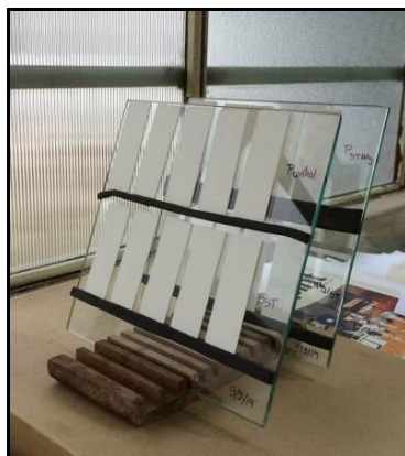
Figura 5.3. Portaobjetos pintados y expuestos a la luz solar a través de un vidrio.
