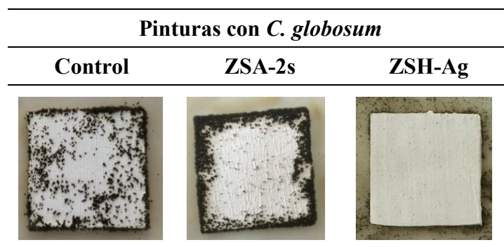
Figura 5.18. Ensayo de bio-resistencia de las pinturas conteniendo los aditivos basados en los óxidos mixtos sílice/circonia frente a C. globosum , luego de 4 semanas.
