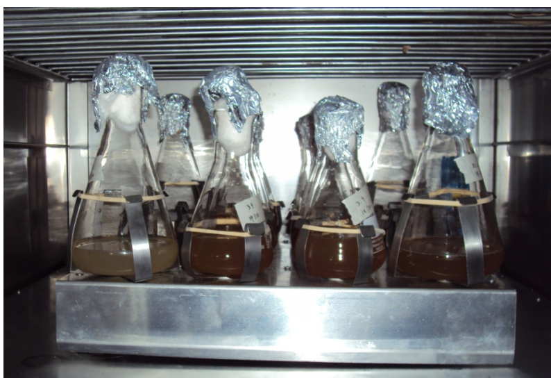
Figura 14. Frascos Erlenmeyer con inóculo de F. graminearum y F. pseudograminearum incubados en agitador rotativo.
