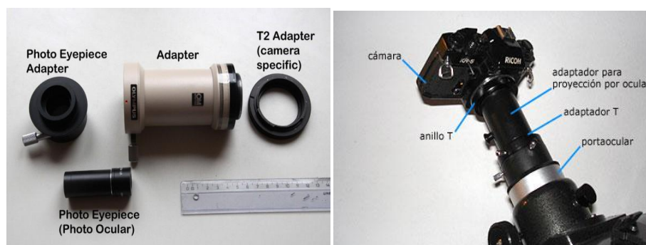
Fig. 7. Adaptación de la cámara de fotografía al ocular del biomicroscopio
