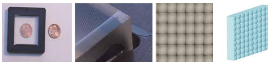
Fig. 8. Arreglo de microlentes, distintas vistas. Fuente:[11]
