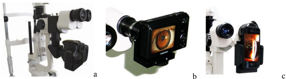
Fig. 3. Diferentes opciones para la captura de fotografías con lámpara de hendidura. a. Sistema de pentaespejos, b. Sistema utilizando un ocular, c. Adaptador ocular para smartphones.
