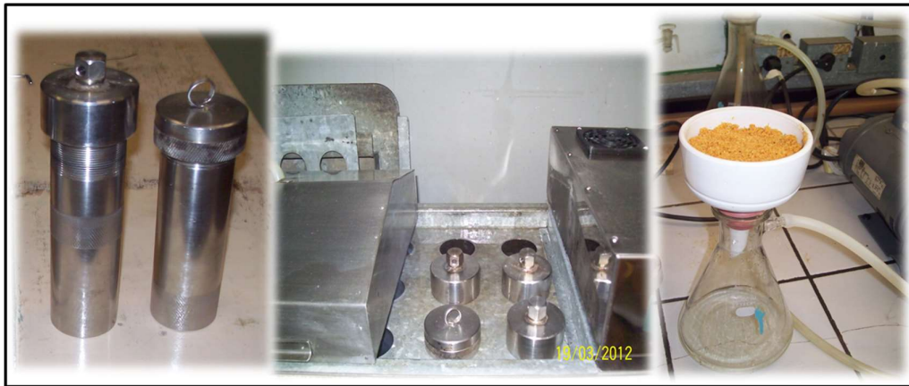
Figura III.10. Reactores de acero inoxidable, baño de glicerina y filtración
