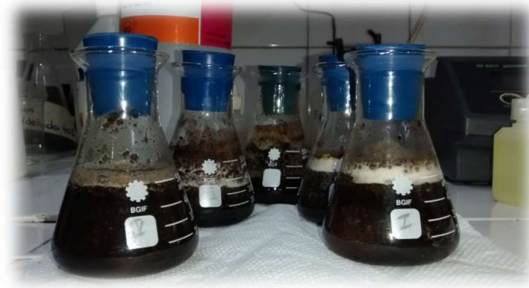
Figura III.14 Tratamientos con peróxido alcalino de aserrín de pino.
