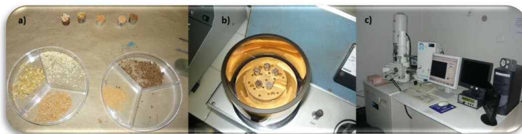
Figura III.4. Análisis microscópico. a) Preparación de muestras (colocación en stub). b) Metalizado con oro. c) Microscopio electrónico de barrido del CME, UFPR.
