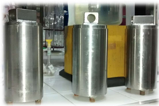
Figura III.13. Reactores utilizados para la etapa deslignificante
