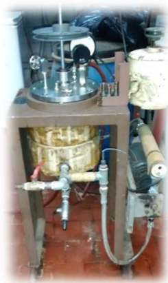
Figura III.15. Reactor multipropósito utilizado en la etapa de oxígeno alcalino
