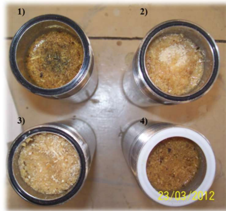
Figura IV.5 Reactores 1 y 4 corresponden a APA y reactores 2 y 3 al aserrín original.
