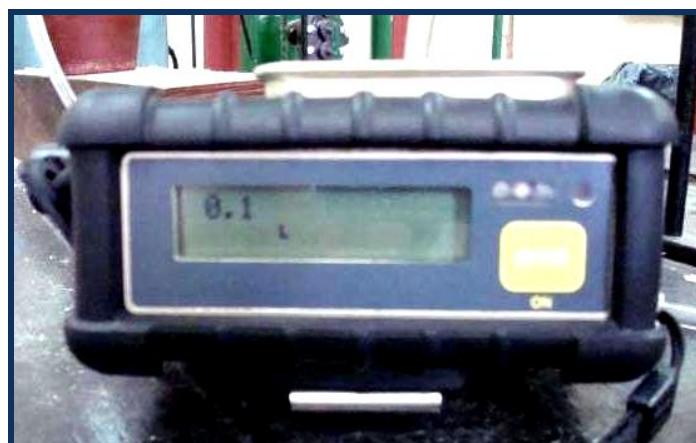
- Figura 22: Medidor de SO 2 SafeLog 100, Quest Technologies, de celda electroquímica y rango de medición de 0.1 - 50ppm. –
