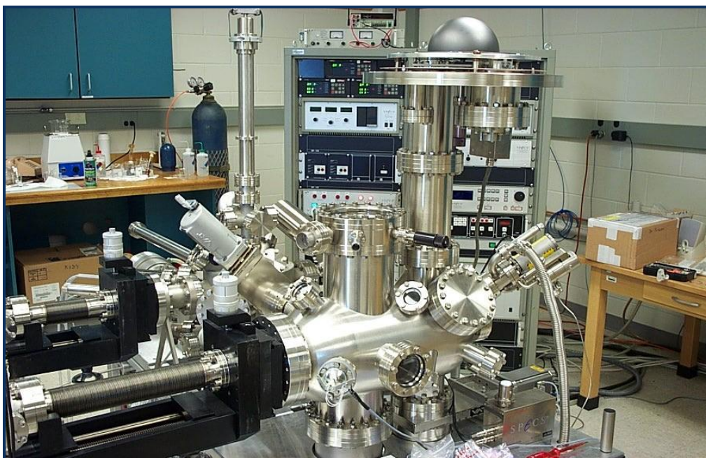
- Figura 63: Espectrofotómetro de Rayos X con el cual se procesaron los resultados presentados en la tesis. Se encuentra en el Instituto de Catálisis de Barcelona, España.-
