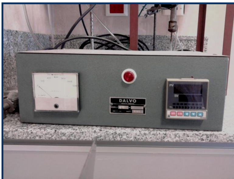
- Figura 20: Horno eléctrico vertical a temperatura programada.-
