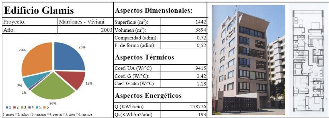
Figura V - 4: Descripción básica del edificio.
