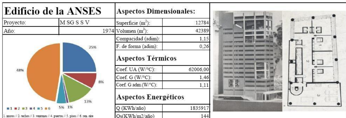
Figura V - 3: Descripción básica del edificio.
