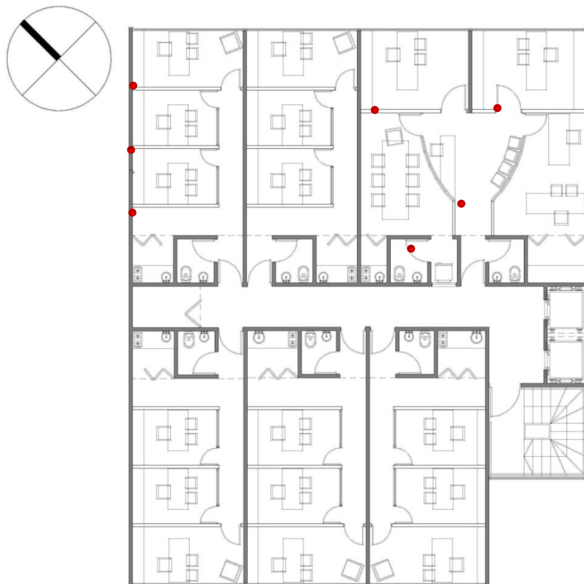
Figura VI - 6: distribución de los HOBOS en uno de los edificios de viviendas auditado.
