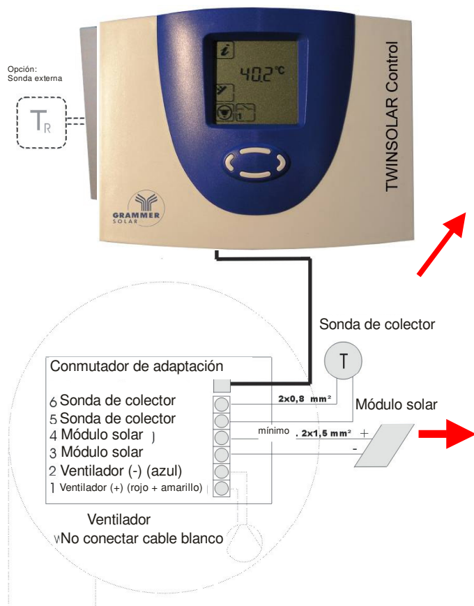
Imagen 3: Esquema de conexión del módulo para instalaciones con 1 ó 2 módulos
