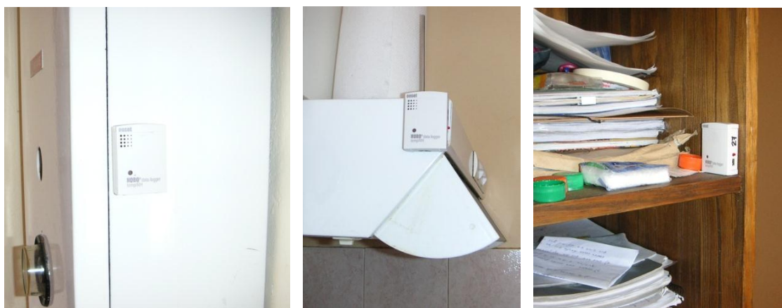
Figuras VI – 8, 9 y 10: colocación de los HOBOS en una de las viviendas auditadas (mediciones de agua caliente, cocción y confort higrotérmico).
