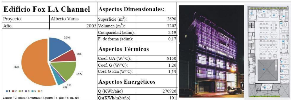
Figura V - 2: Descripción básica del edificio.
