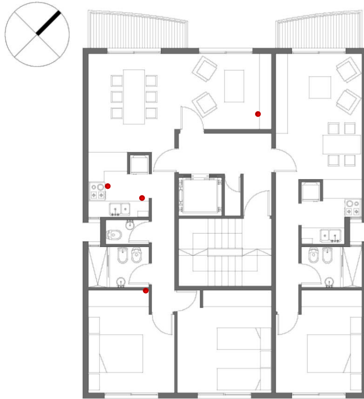
Figura VI - 6: distribución de los HOBOS en uno de los edificios de viviendas auditado.
