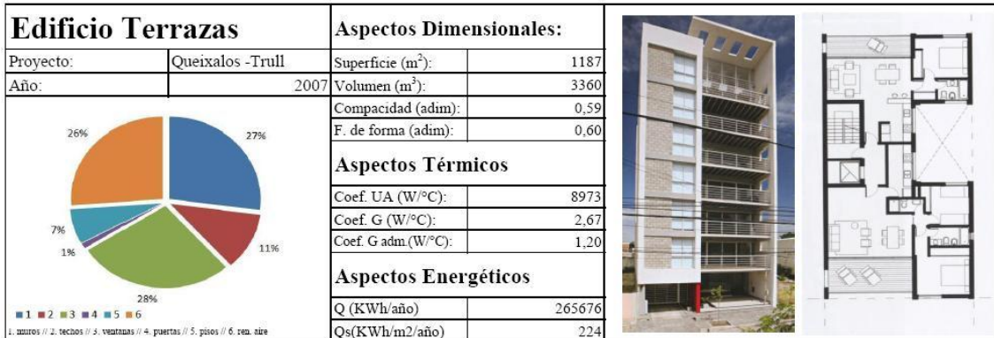
Figura V - 6: Descripción básica del edificio.
