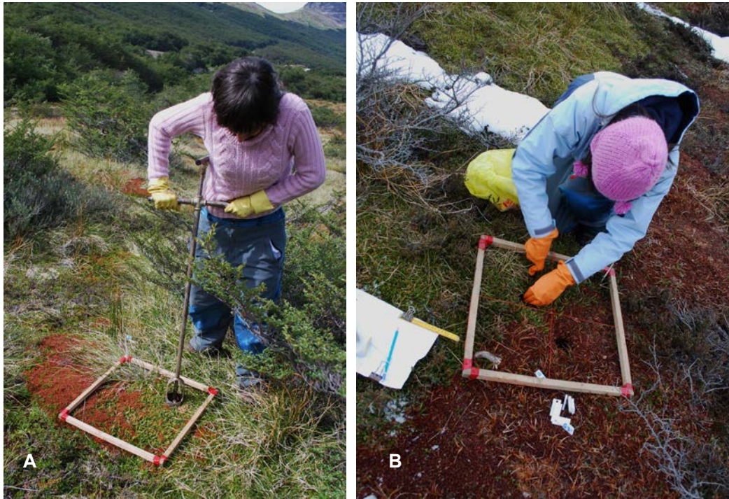
Figura 10. Recolección de muestras de turba con barreno (A) y cuchillo dentado (B) en una turbera compacta de Astelia en Tierra del Fuego.
