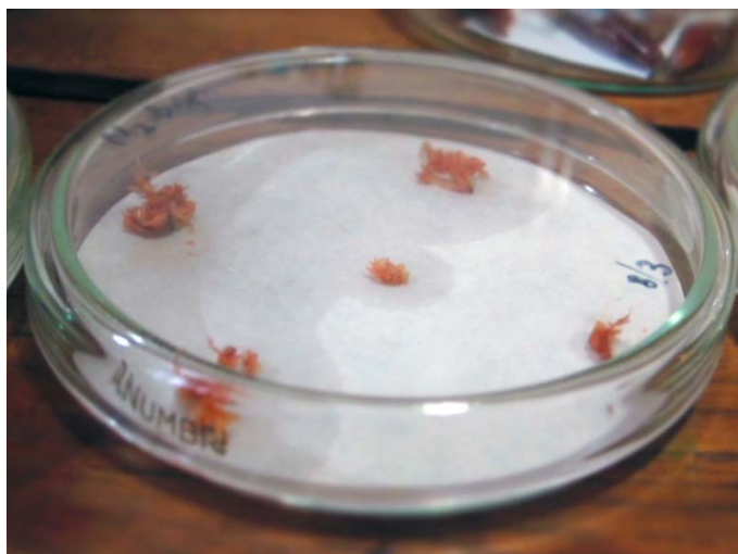
Figura 18. Cámara húmeda realizada con 5 porciones de turba fueguina de Sphagnum .
