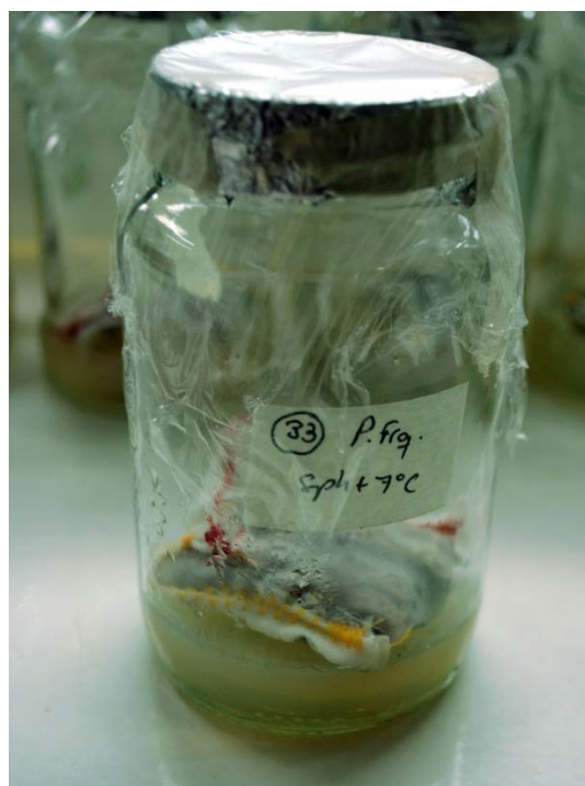
Figura 28. Unidad experimental utilizada en el ensayo de microcosmos para evaluar la descomposición de distintos tipos de turba incubada con especies de hongos nativos de turberas compactas de Tierra del Fuego.
