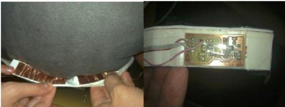
**Figura 4-18:** Prototipo implementado del CDRL, utilizado para obtener medidas experimentales de ECG
