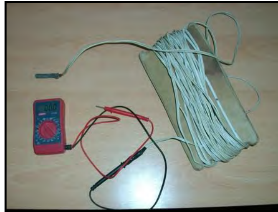
Figura 7. Sonda utilizada para la medición de niveles.
