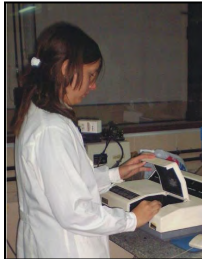
Figura 14. Espectrómetro para la medición de sulfatos y nitratos.
