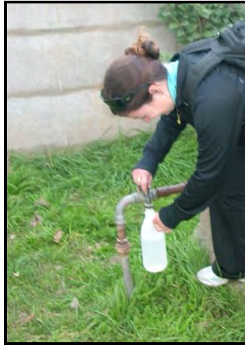
Figura 8. Toma de muestra para análisis químico.
