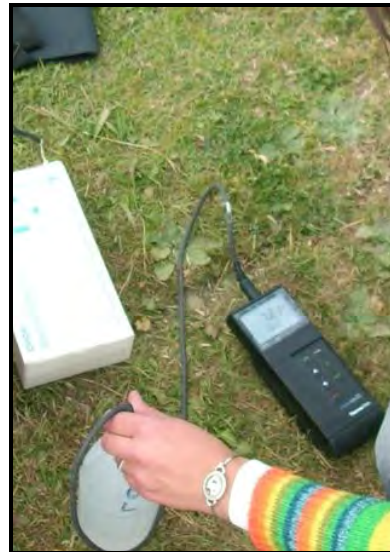
Figura 10. Medición de conductividad eléctrica en un sitio de muestreo.
