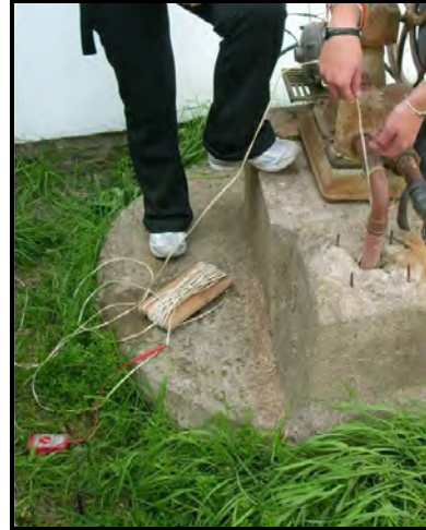
Figura 6. Medición del nivel freático en perforación con bombeador.
