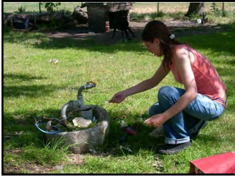
Figura 5. Medición del nivel freático en perforación con bomba sumergida.
