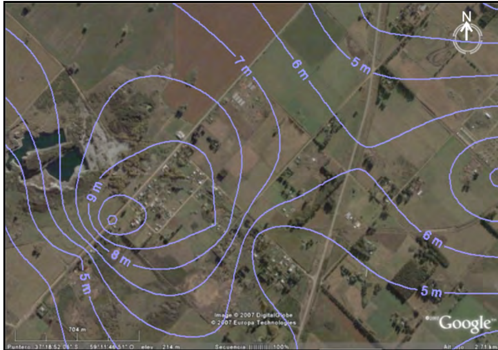
Figura 30. Mapa de isopropfundidades del nivel freático para diciembre 2007.
