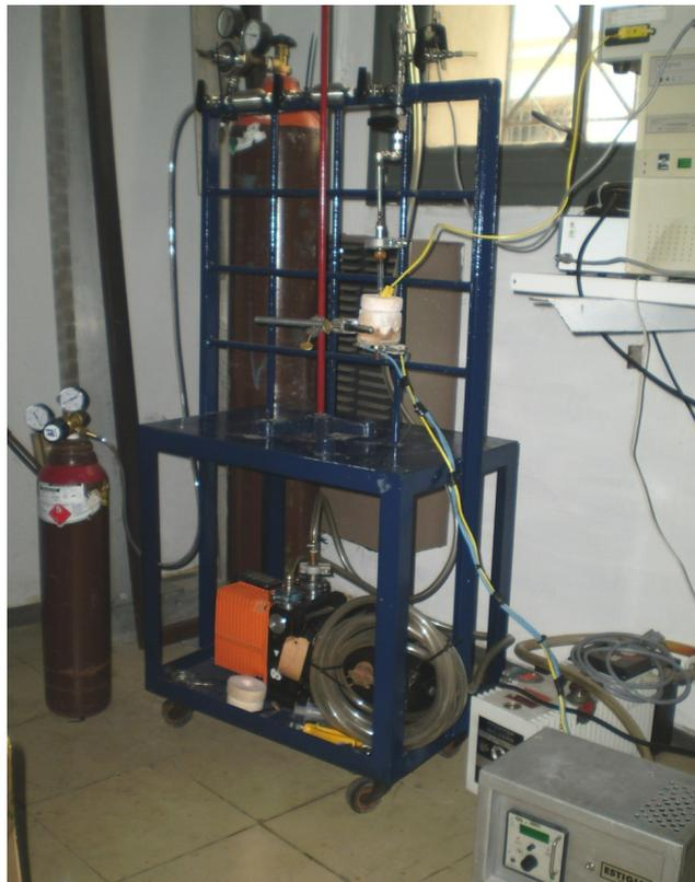
Figura 4.14.- Sistema de Hidrogenación de Laboratorio utilizado en los ensayos de carga y descarga de hidrógeno en los distintos materiales estudiados.
