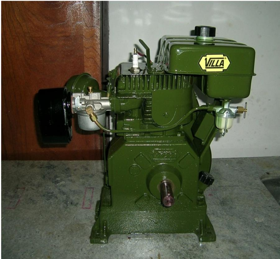
Figura 4.1.- Motor de combustión interna Villa de cuatro tiempos, monocilíndrico, refrigerado por aire, para funcionar con nafta.
