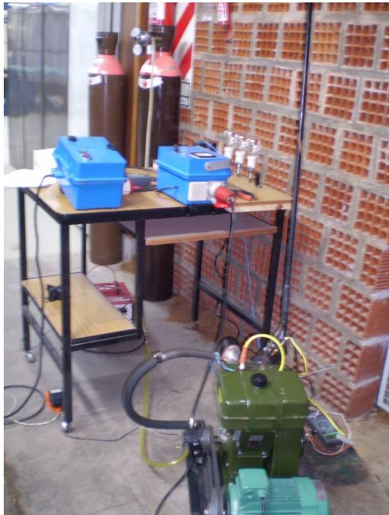
Figura 4.6.- Motor con los dos tubos de mezcla  $\text{CH}_4\text{-H}_2$  que están conectados mediante una manguera de plástico por donde fluye el combustible a baja presión hacia el motor.
