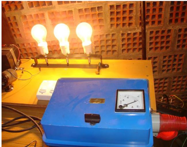
Figura 4.5.- Se muestra las tres lámparas óhmicas utilizadas en los ensayos con el motor disipando un total de 600 watts.
