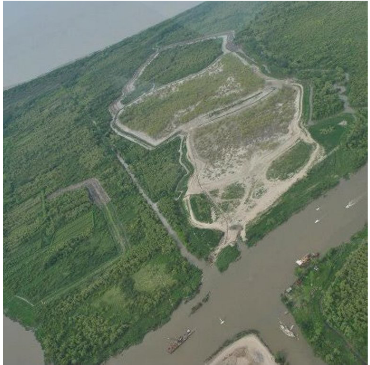
Figure 5- . Disposición de parte del refulado producto del ensanche del canal central
