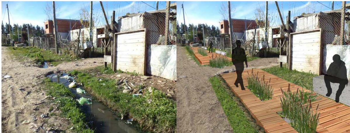
Figura 8- Propuesta diseño de veredas con dispositivo de fito-remediación (fotomontaje antes-después) Fuente: Laboratorio Bio-Ambiental de Diseño-UFLO
