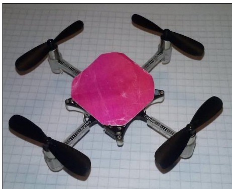
Fig 5. Cuadricóptero con identificación de color
