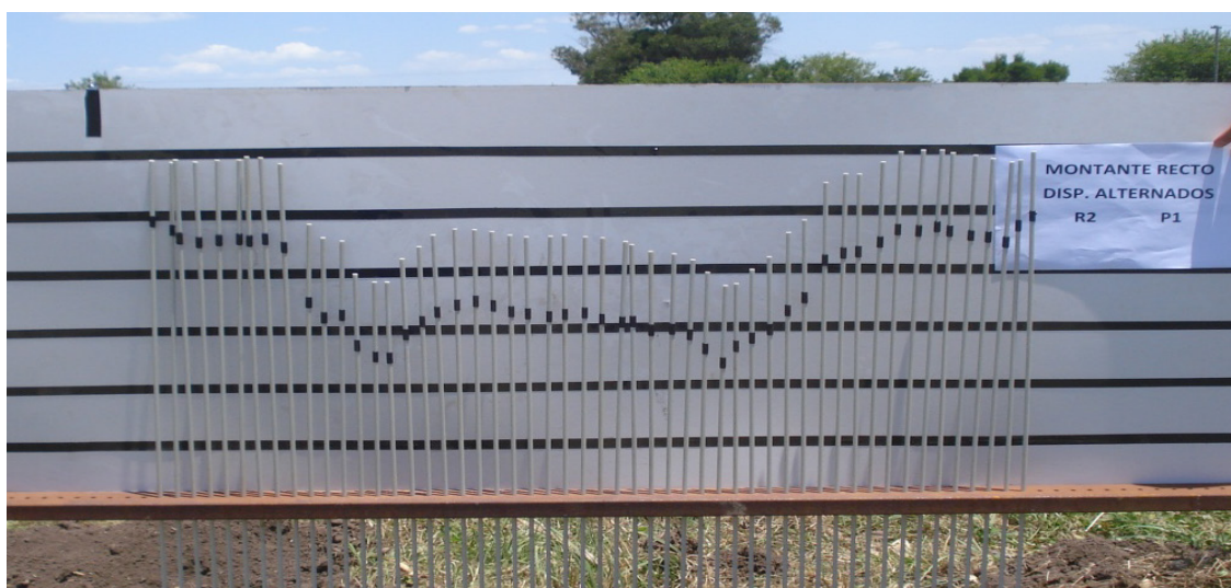
Foto 10. Características de roturación de montante angulado recto (AR).
