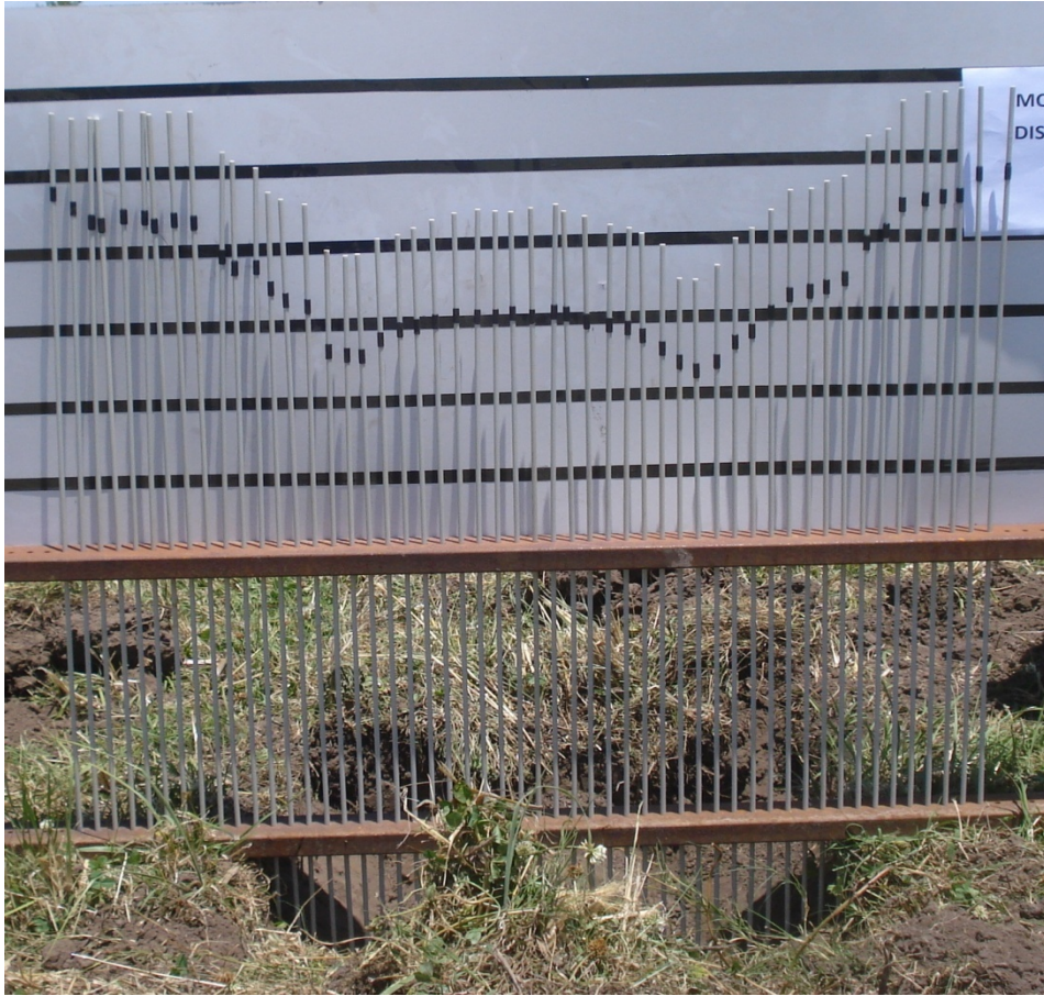
Foto 8: Perfilómetro utilizado en el ensayo, similar al descrito por Willat & Willis (1965) y por Stafford (1979).
