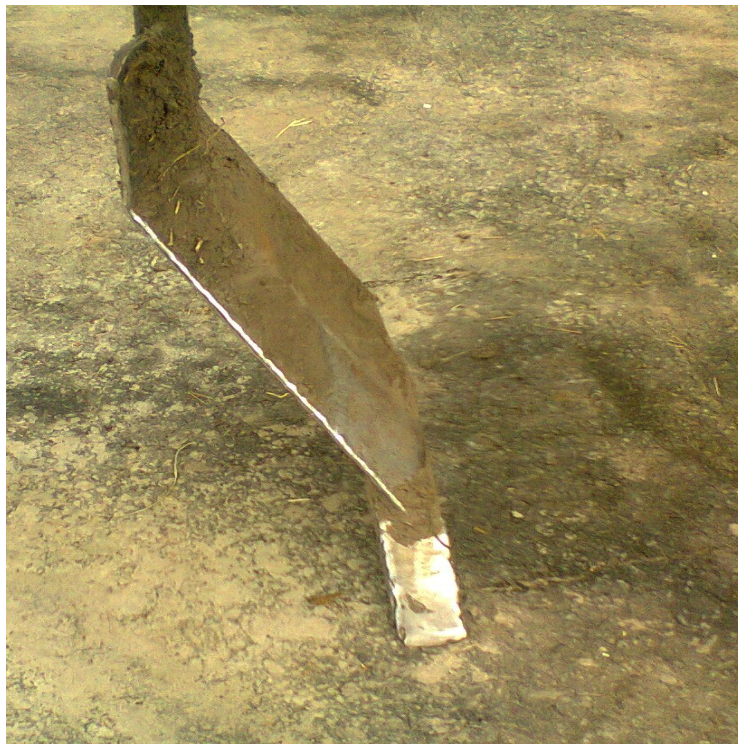
Foto 3: Vista anterior del montante angulado lateral de lámina recta (AR).
