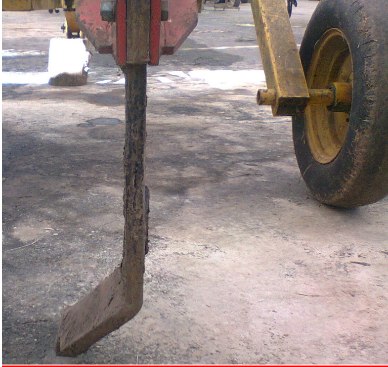
Foto 2: Vista anterior del montante angulado lateral de lámina recta (AR).
