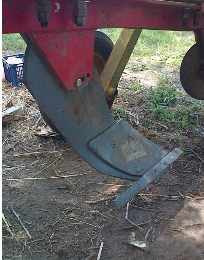
Foto 4: Montante angulado lateral de lámina curva (AC).
