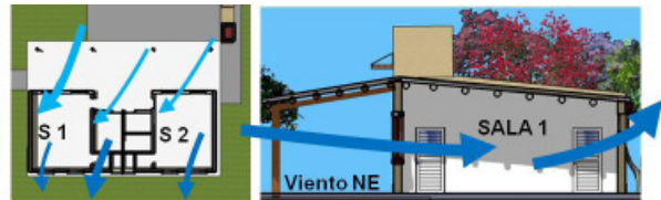
Figura 24: Rediseño: V.C. y efecto chimenea
