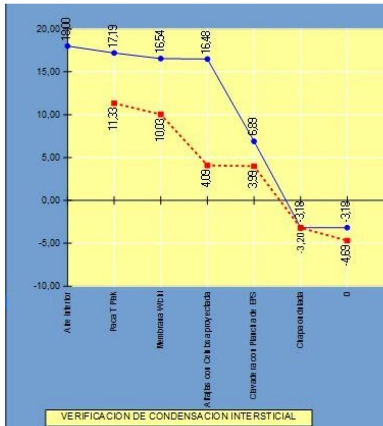
Imagen 41- Gráfico de Condensación de Cubierta Versión Mejorada
