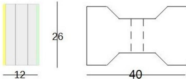
huevo central que permite reforzar con estructura, o colocar instalaciones o rellenar y una mezcla intermedia de Poliestireno Expandido (EPS) como residuo recuperado (RSU) para mejor aislación térmica y reducción de peso, se utilizó también cola común con la que se obtuvo un buen resultado en la experimentación.
