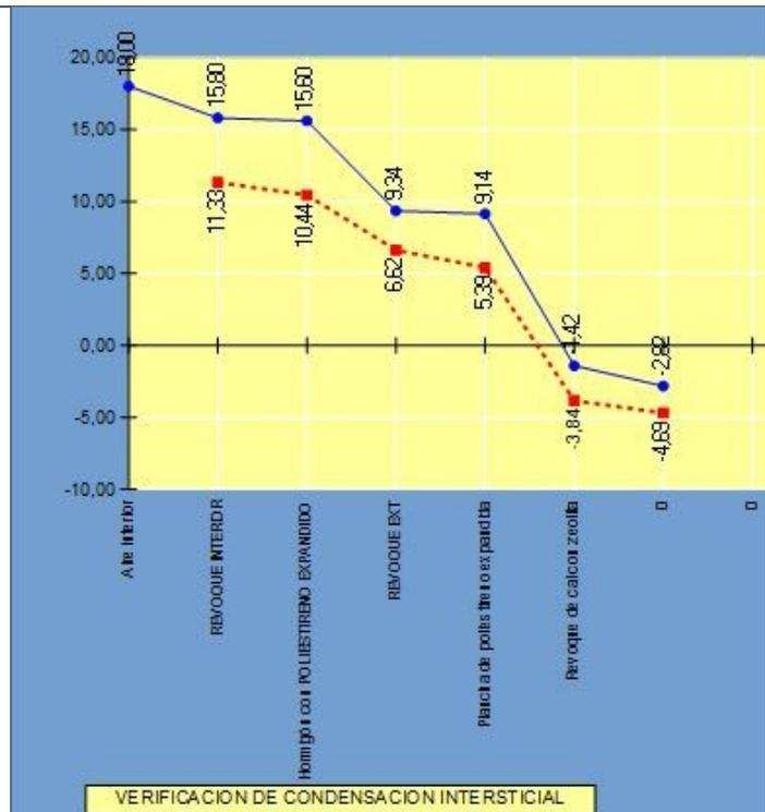
Imagen 40- Gráfico de Condensación de Muro con Bloque H Mejorado
