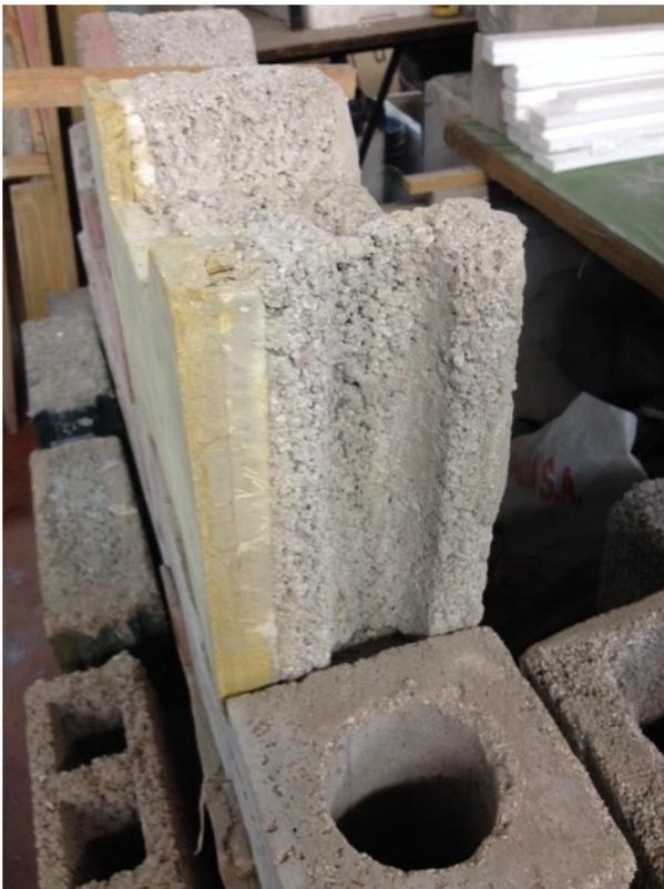
Imagen 39- Bloque H con 4 cm de aislación térmica exterior
