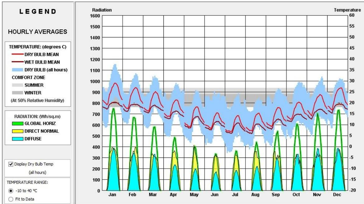
Imagen 22 -Diagrama de Análisis de Radiación y Temperatura mes a mes y zonas de confort
