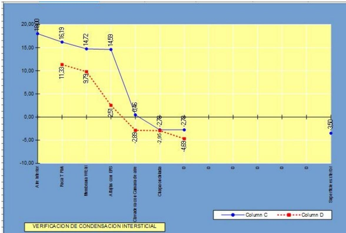
Imagen 38- Gráfico de Condensación de la cubierta existente
