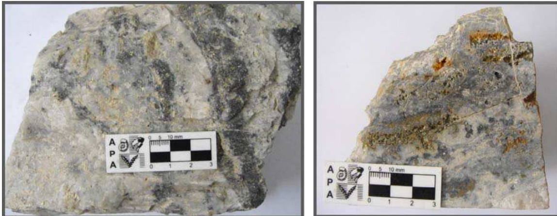
Figura 4.78 Detalle de las texturas bandedas analizadas en la veta Huevos Verdes. En ella se identifican dos pulsos, uno de cuarzo blanco con escasos sulfuros y otro de cuarzo-sulfuros de color más oscuro, el cual fue ensayado en el laboratorio de Inclusiones Fluidas de la UNS, Bahía Blanca.
