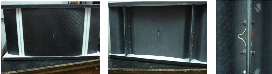
Figura 14: extensómetros en el panel
