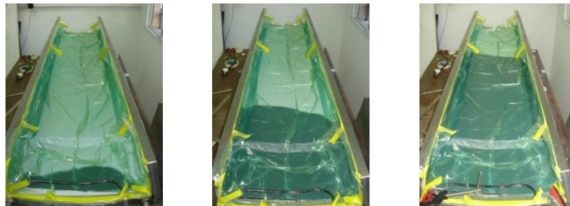
Figura 10: patrón de infusión en la preforma.
