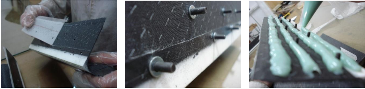
Figura 12: secuencia de unión de las partes.
