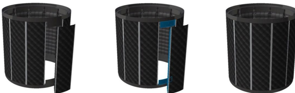
Figura 21: secuencia de pegado para cada panel (en azul las áreas donde se aplica el adhesivo).
