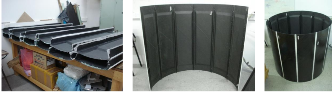
Figura 20: fabricación de los paneles cilíndricos que conforman la sección de fuselaje.
