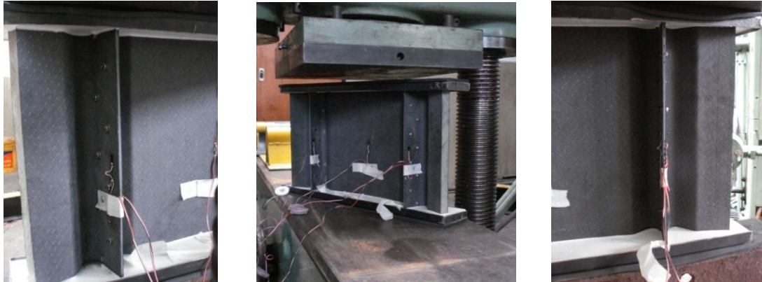
Figura 16: disposición del panel en la máquina de ensayos.
