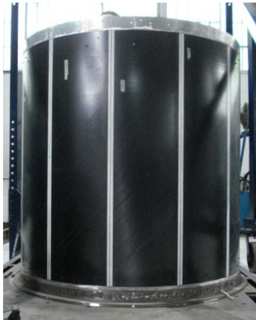
Figura 23: Sección de fuselaje terminada.
