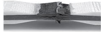
Figura 12. Rotura por compresión.
