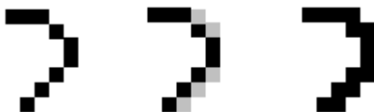
Figura 6: Las líneas 1 y 3 han sido adelgazadas con los métodos de CC y Zhang-Suen respectivamente. La línea central muestra la “diferencia” entre ambas.
