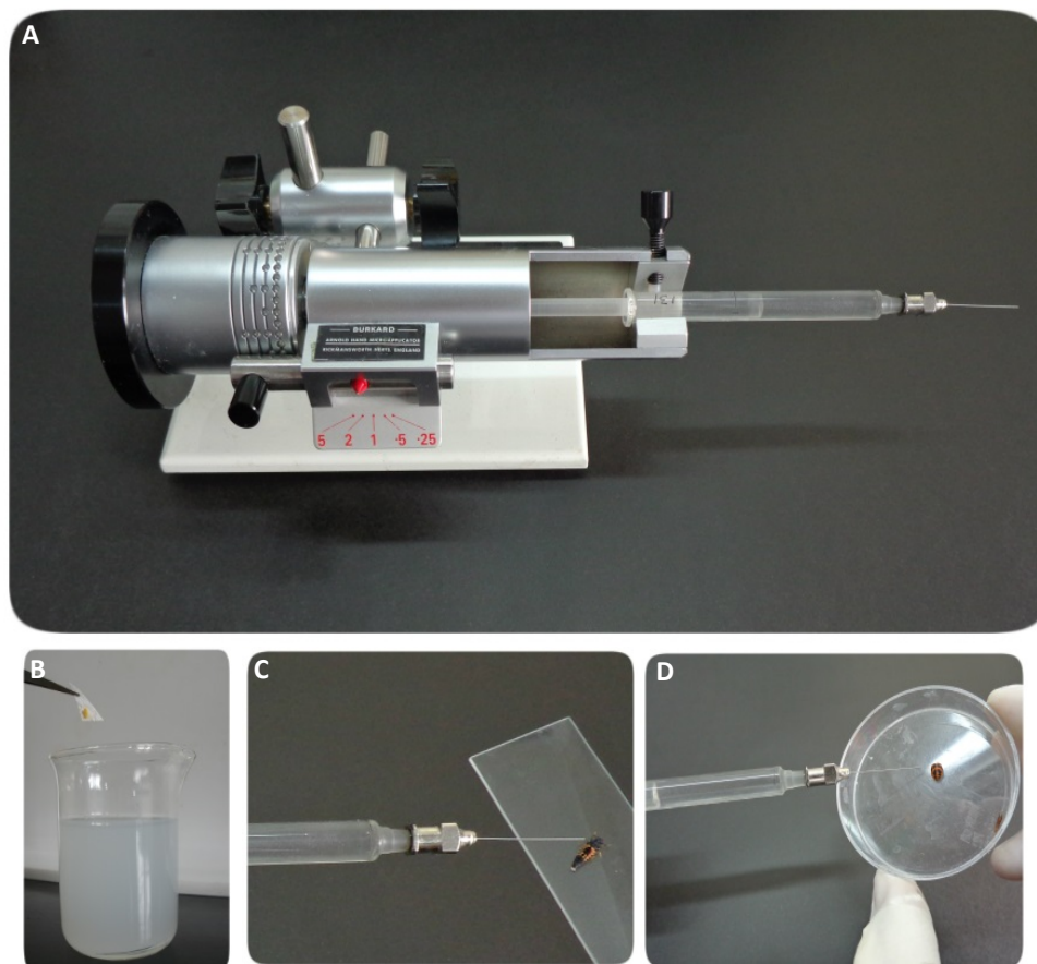
Figura 5.1. Exposición de Harmonia axyridis a insecticidas. A: Microaplicador manual de precisión, Burkard®. B: Exposición por inmersión de huevos. C: Exposición tópica de larva del cuarto estadio. D: Exposición tópica de pupa.
