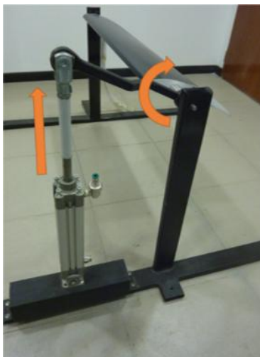
Figura 6. Mecanismo de cambio de ángulo de ataque brusco.
