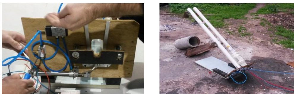
Figura 8 Sistema de liberación neumático remoto y plataforma de lanzamiento (Cátedra)
