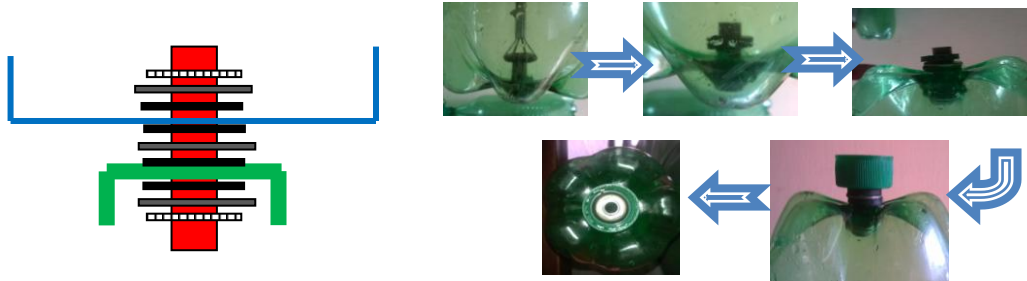
Figura 9 Esquema y detalle de sistema de acople tipo Robinson (L. Castelli)
