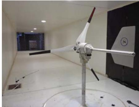
**Figura 1.** Generador ensayado dentro del túnel aerodinámico
