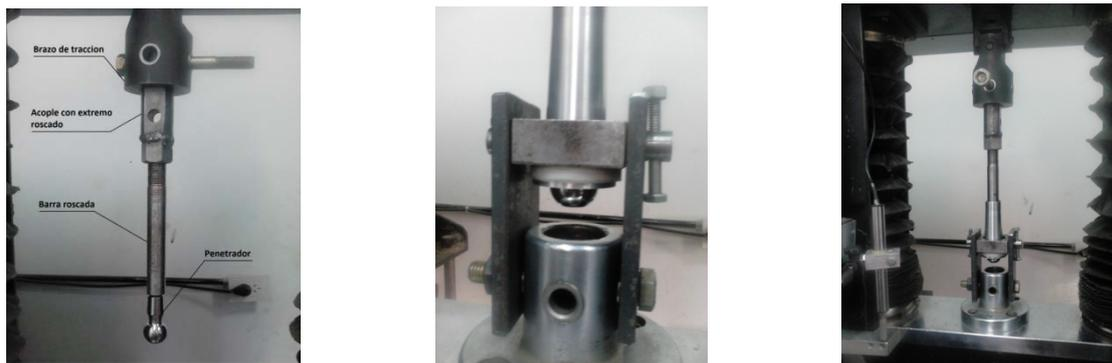
Figura 7. Montaje, ensayo cuasi-estático.
