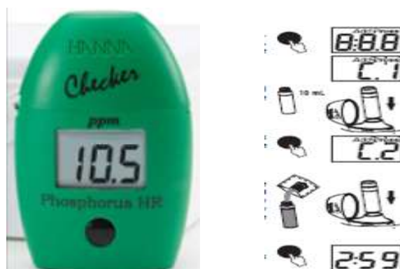
Figura 3: Fotómetro monoparamétrico y procedimiento de análisis.
